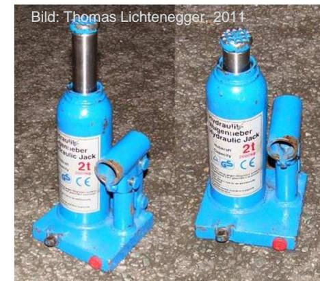
Ein hydraulischer Wagenheber ist flexibler und leichter hand zu haben als sein mechanisches Äquivalent. Außerdem kann ein kompakterer Heber eine größere Masse heben.
