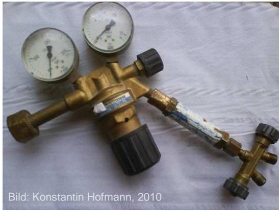
Der Druckminderer sorgt im Vergleich zum herkömmlichen System dafür, dass bei verschiedenem Eingangsdruck immer der gleiche Ausgangsdruck eingestellt werden kann.
