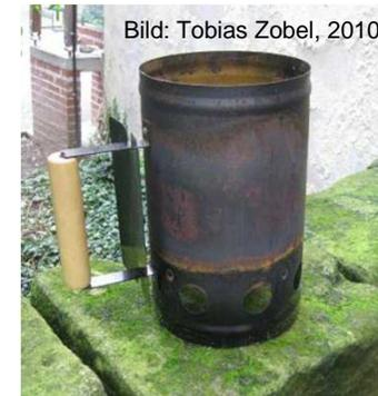
Durch die Löcher auf der Unterseite des Grillkamins entsteht ein Sog, der Luft ansaugt und die im oberen Teil befindliche Grillkohle wesentlich schneller erhitzt, als beispielsweise bei einer unbelüfteten Grillhaufen.
