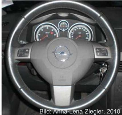
Lenkrad mit Bedienelementen für Autoradio und Bordcomputer. Bei der vorhergehenden Generationen erfolgte die Bedienung der Geräte unmittelbar am Gerät selbst.
