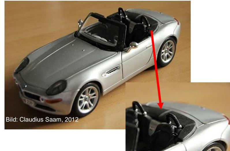
Der fest montierte Überrollbügel wird aus Design Gründen durch einen versenkbaren Überrollbügel ersetzt. Im Ernstfall fährt der Bügel vor dem Überschlag aus.
