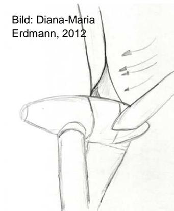
Im Fliehkraftdrehzahlregler für Windkraftanlagen werden die Fliehkraftgewichte als Flügel mit negativem Anstellwinkel ausgeführt. Dadurch erhält man eine aerodynamische Bremskraft bei zunehmender Windstärke. Windkraftanlagen ohne diese Anstellwinkel können im Sturmfall nicht nach vorne gedreht werden, sondern die Anlage muss aus dem Wind geschwenkt werden.
